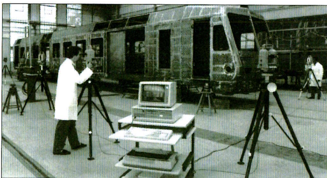
Figure 8. Contrôle de la forme de la carrosserie au millimètre près, par intersection spatiale, au moyen de plusieurs théodolites de précision © Leica
