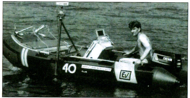
Figure 9. Les points du fond de l'eau sont repérés au moyen du GPS (X,Y) et du sonar (Z) © Leica
